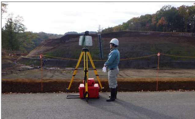
写真-1 地上型レーザースキャナー（TLS）による起工測量
