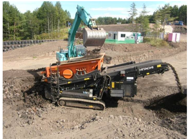
図-5 自走式スクリーンによる土砂のふるい分け
