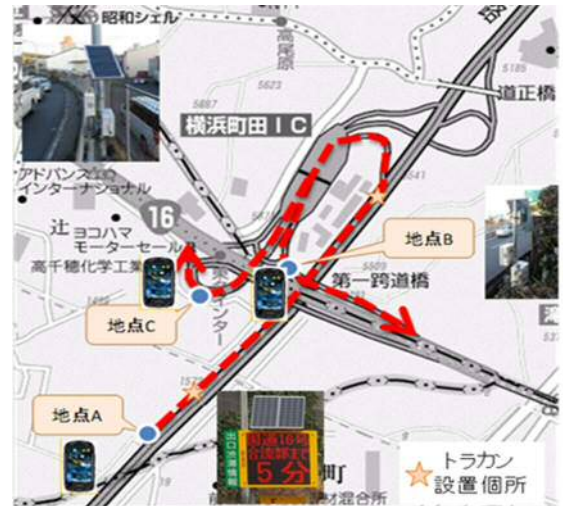
図-12 Bluetooth 配置図 (横浜町田 IC)
