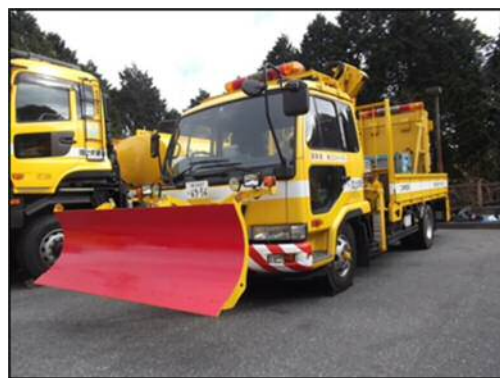
図-5 簡易スノープラウ装着状況
