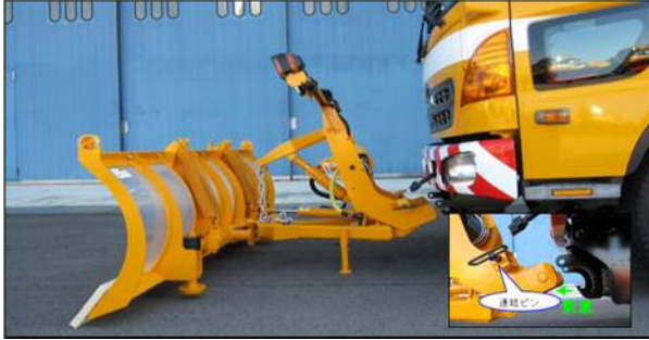
図-7 車両とプラウ本体との接続方法
