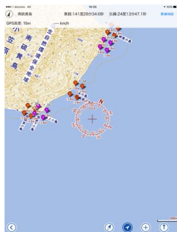
図-5 タブレットを用いたGPSナビゲーション
