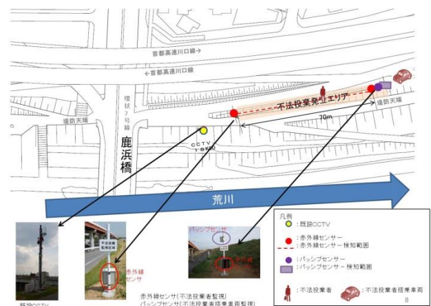
図-9 不法投棄監視に係わる設備設置状況
