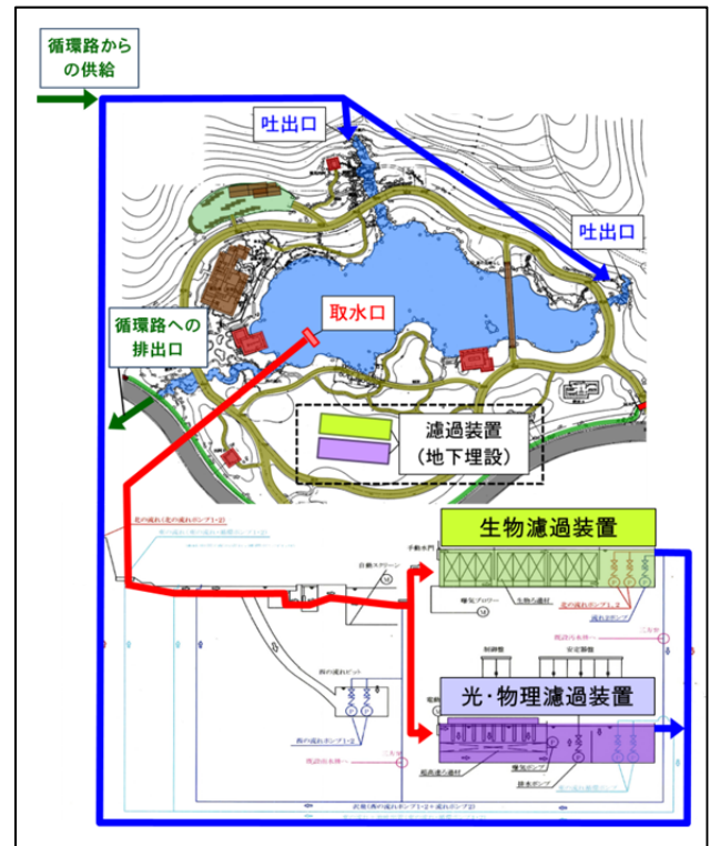
図-3 循環濾過装置の概要
