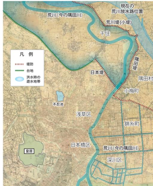
日本堤・隅田堤の位置と効用 (資料:「迅速測図」より作成)
