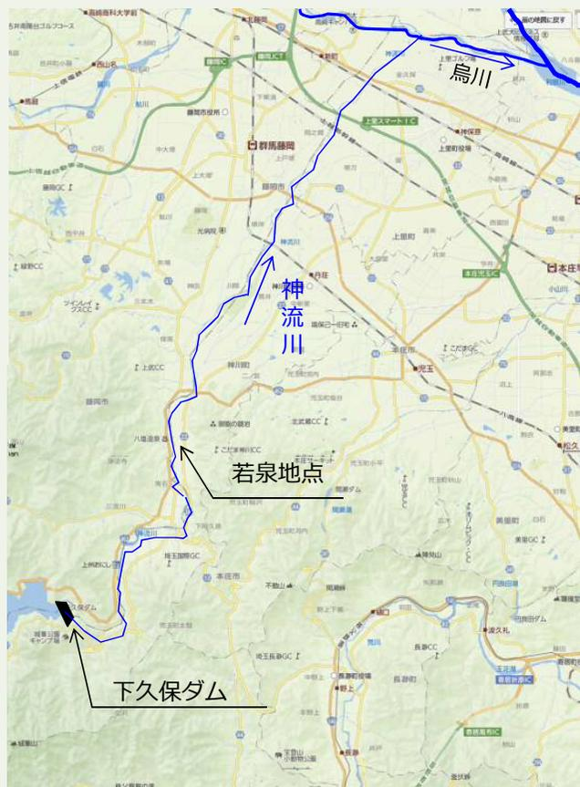
ダムの計画規模内（最大流量2,000m<sup>3</sup>/s以内）の中小洪水に対しては、ダムの容量を最大限活用するため、時々刻々の空き容量とその時点の流入量状況から放流量を設定することで、下流の若泉地点において洪水時の河川流量を減少させる操作の可能性について確認できた。
