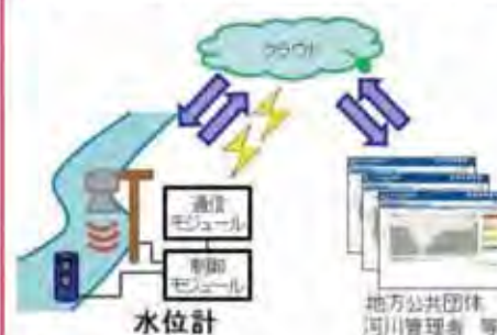
洪水時に特化した低コストな水位計
