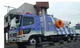
排水ポンプ車
