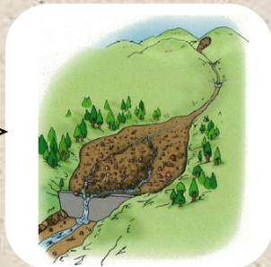
②大雨と一緒に大量の土砂が流れてくると、川の勾配が緩い堰堤の上流側で水のスピードが遅くなり、既にたまっていた土砂の上にさらに大きく一部土砂が積もってたまる
