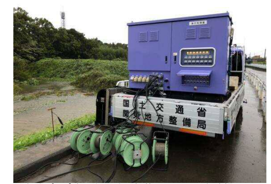
排水ポンプ稼働状況(宮下樋管) 10月23日午後撮影
