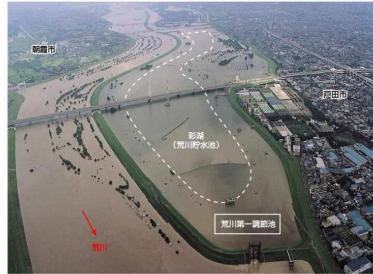
平成11年8月の洪水調節状況(調節池下流から)
