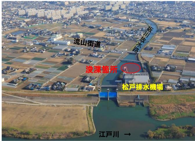
H29松戸河川維持工事（金杉建設）による松戸排水機場周辺の浚渫が終了しました。川底の土砂は約2m堆積しており、全体で3,200m<sup>3</sup>の土砂を撤去しました。土砂撤去により施設の機能維持が図られ、来年度の出水期に備える事ができます。
