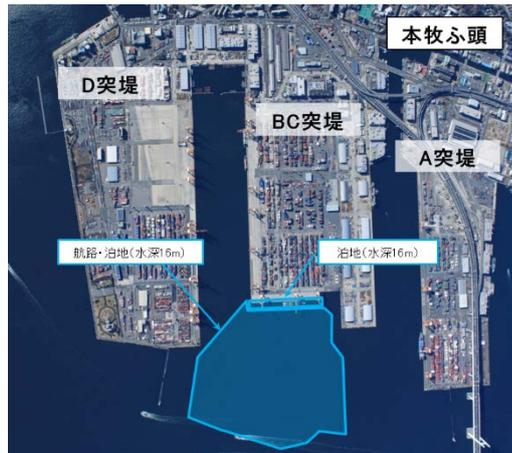
本プロジェクトの実施による岸壁の増深効果により大型化したコンテナ船による輸送が可能となる。
