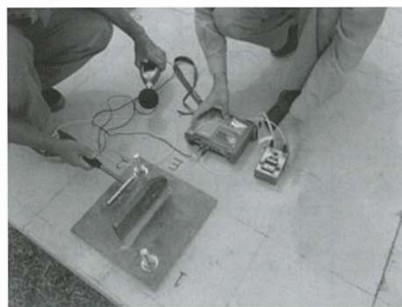
写真-2 ジェットファン用アンカー打音構内試験
