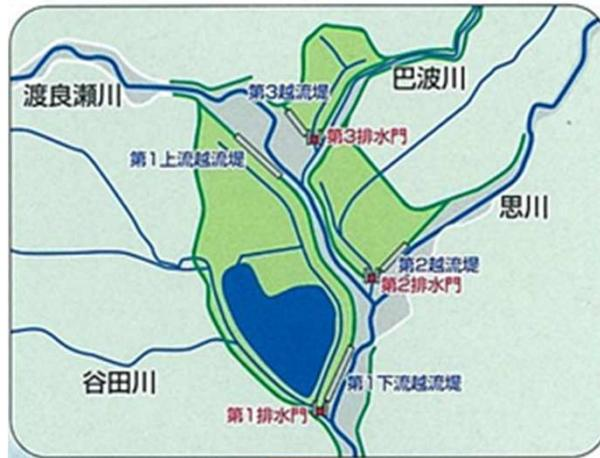
② 洪水時には越流堤より遊水地内へ水が流れ込み下流に流れる水の量を減らす。
