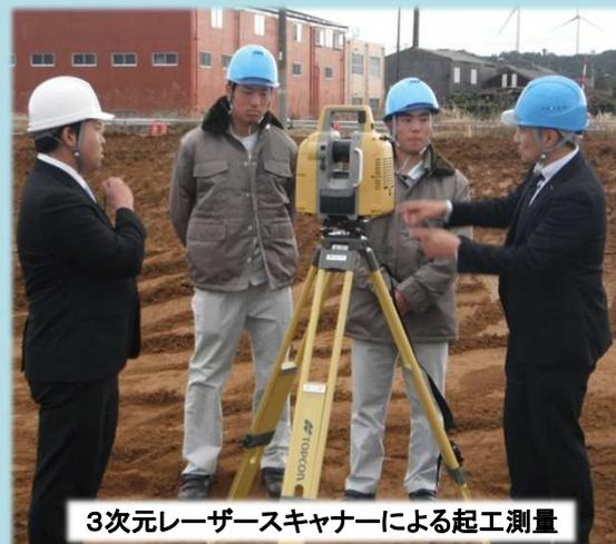
3次元レーザースキャナーによる起工測量
