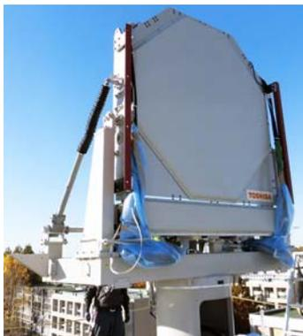
MP-PAWR (Multi-Parameter Phased Array Weather Radar: マルチパラメータ フェーズドアレイ気象レーダ)
