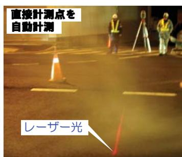
(a) 従来管理（水系・巻尺） (b) TS管理（プリズム方式） (c) TS管理（ノンプリズム方式）
