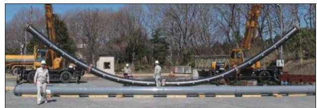
写真-3 高密度ポリエチレン管の継手要素試験
