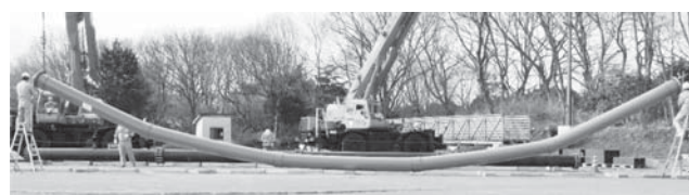
写真—5 硬質塩化ビニル管の継手要素試験
