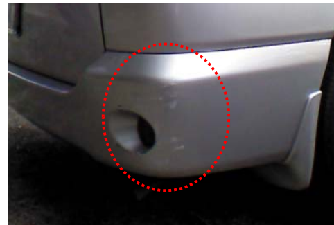
リアバンパー右側を損傷
