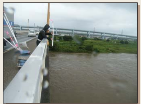
▲洪水時の流量の観測状況
