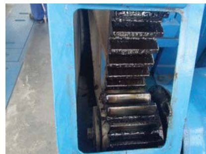
劣化途上にあるピニオンギア （注意：左の設備とは異なるギア）
