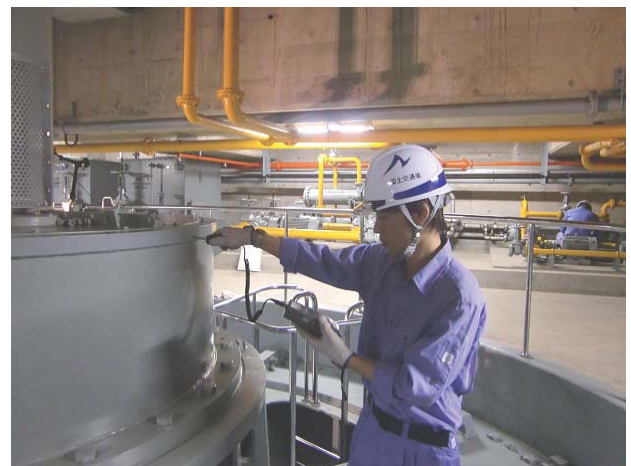
Fig.1 加速度計による測定方法
