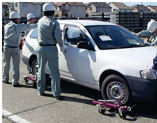
写真-10 新型車両移動用ジャッキの機能検証状況
