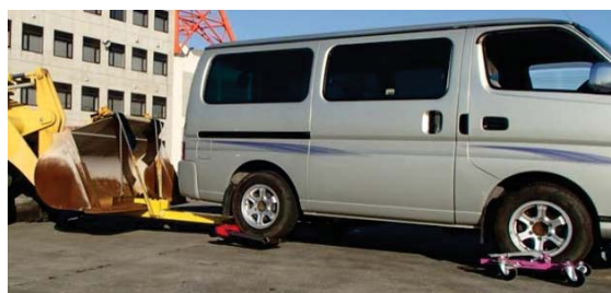
写真-11 ホイールローダ用車両移動機器の機能検証状況
