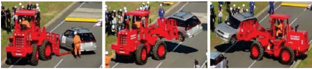
写真-3 ホイールローダでの乗用車の持ち上げ作業
