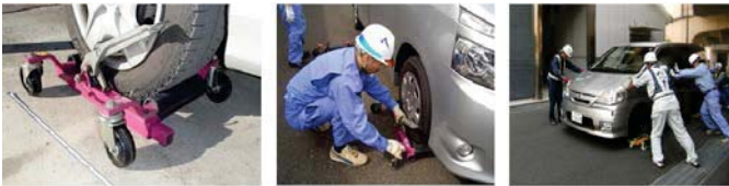
写真-4 車両移動用ジャッキでの乗用車の移動作業
