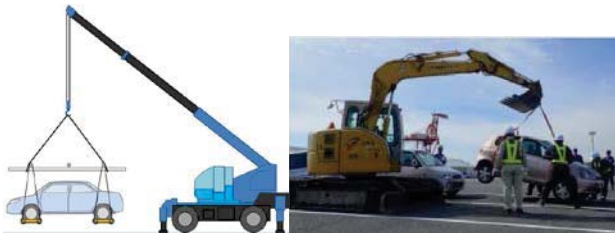
写真-5 クレーン装置による乗用車の吊り上げ作業
