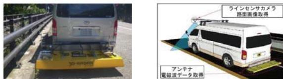
写真-1 車載式レーダー装置    図-1 レーダー探査システム
