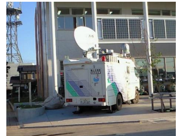
衛星通信車での通信回線の確保
