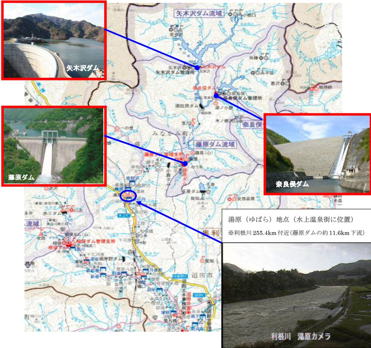
矢木沢ダム、奈良俣ダム、藤原ダムで貯留することにより、下流の湯原地点の水位は、ダムが無いと仮定した場合の水位と比較して、約90cm水位を低下させたと想定されます。
