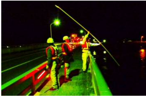
流量観測状況 「浮子」投下 (栄橋 10月24日 0:00)
