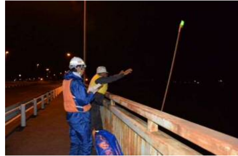
流量観測状況 「浮子」投下 (水郷大橋 10月24日 3:00)
