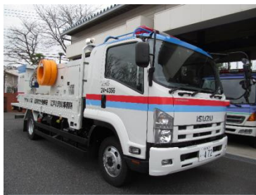
排水ポンプ車 (30m 3 /分)
