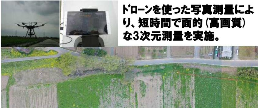
ドローンを使った写真測量により、短時間で面的(高画質)な3次元測量を実施。
