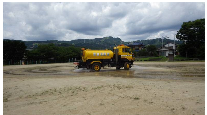
安全な離着陸を支援するため、散水作業を実施し砂埃の飛散防止を図った。
