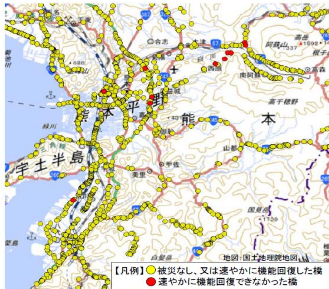
図-1 緊急輸送道路の橋の耐震性能の発揮状況 (熊本県内で震度6弱以上を観測した主な地域)
