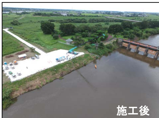
関宿水閘門左岸上流におけるポンプ車ヤードの整備
