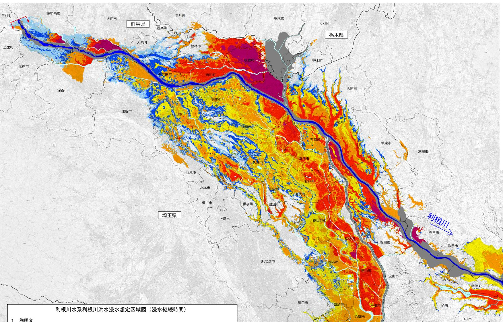
利根川水系利根川洪水浸水想定区域図（浸水継続時間）
