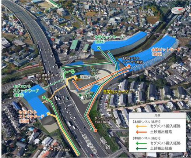
図-4 東名JCT工事（シールド機組立・坑外設備配置）
