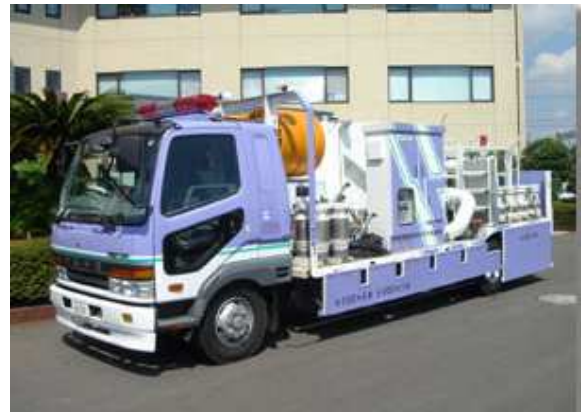
排水ポンプ車
