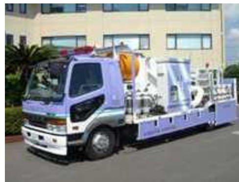
排水ポンプ車
