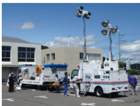
ポンプ車・照明車
