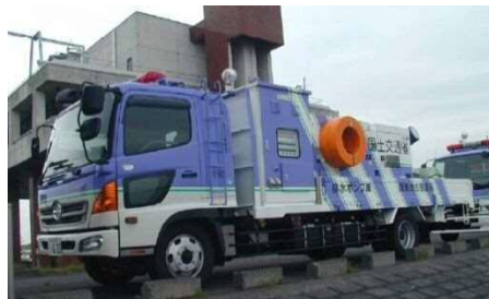
排水ポンプ車
