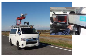
MMSによる計測状況
