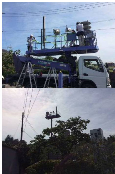
複数機種によるスピーカー性能試験の様子
