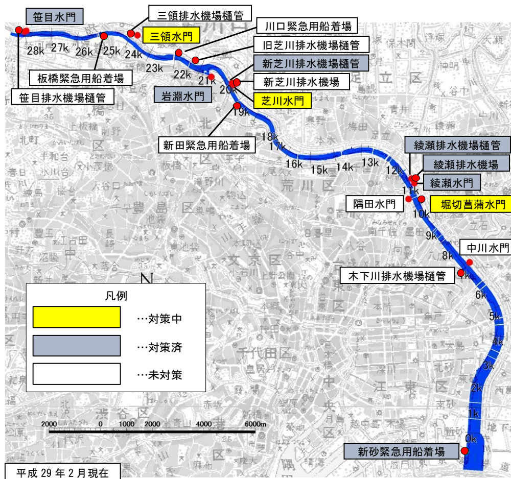
図 3-5 L2 耐震対策の必要な施設
