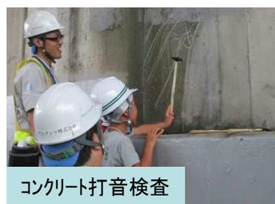
コンクリート打音検査
