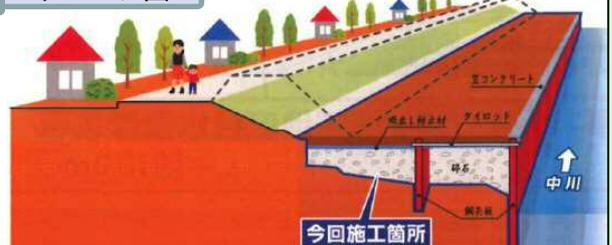
この工事では、今後堤防整備を行うにあたり、現在ある河川敷では堤防整備に必要な敷地が確保出来ないため、河川敷の幅を広げて堤防整備が行えるよう、既設の護岸より川側に新たな低水護岸(平場)を新設する工事を行っています。
