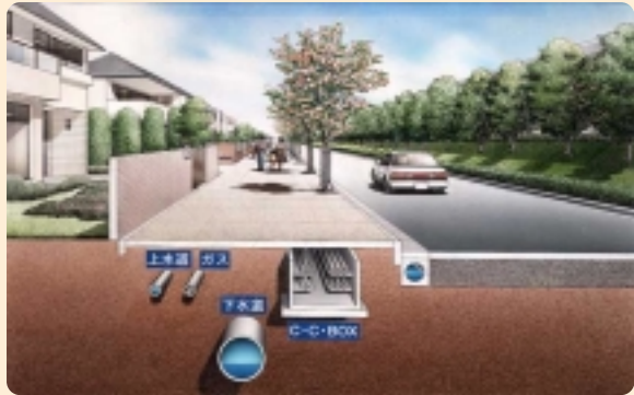
C・C・BOX / 電気や電話などの電線を収容するため、道路の地下に埋設する施設のことです。
