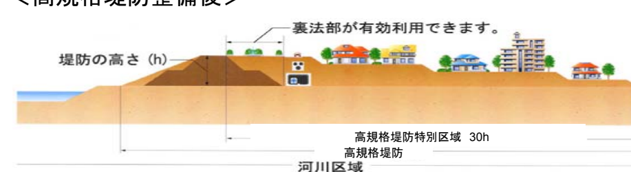
<高規格堤防整備後>
